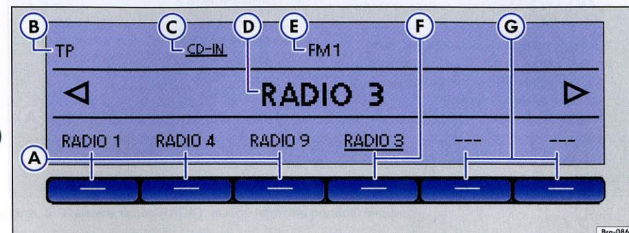
Илл. 4 Режим радиоприёма с индикацией кнопок вызова радиостанций.
