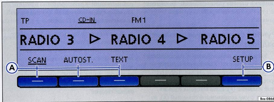
Илл. 8 Вызов дополнительных функций радио: сканирование включено.
